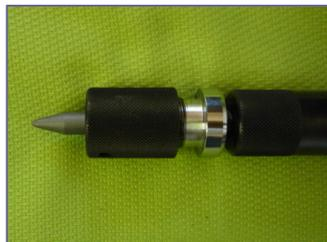
3. アダプターの本体部分を把持してドライバーを回転させると、頭部が前後に微振動します。
