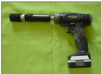
2. アダプターに先端工具を取り付けます。
